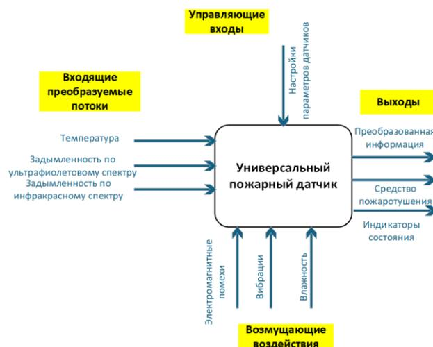
Рис. 1. Параметрическая модель универсального пожарного датчика
