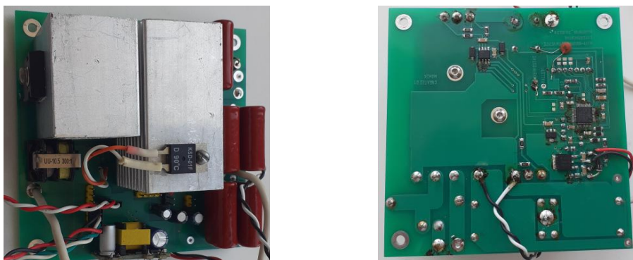
Рис. 4. Плата силовой части источника для полуавтоматической сварки высокочастотным переменным током – слева лицевая сторона, справа – обратная
