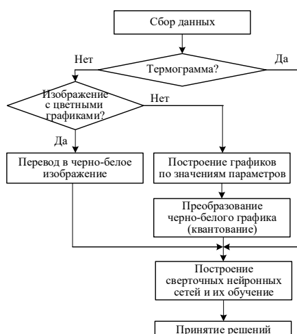
Рис. 3. Алгоритм комплексного подхода к обнаружению неисправностей электрооборудования
