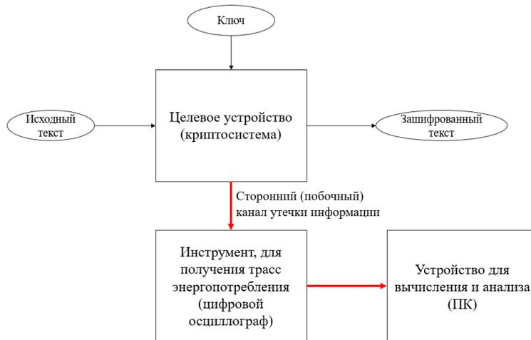
Рис. 2. Структура стенда для проведения атаки по энергопотреблению.
