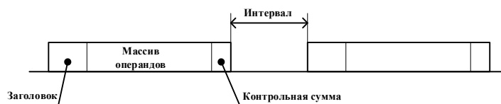
Рис. 3. Передача данных массивами операндов
