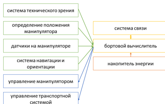
Рис. 1. Принципиальная схема универсального робота для плодовых садов
