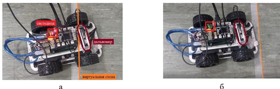
Рис. 6. Два подъезда робота к стене: а – столкновение; б – остановка перед стеной
