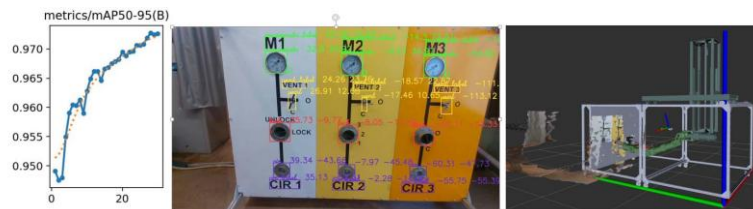
Рис.6. Результат метрики точности обучения модели (mAP50) и работы ИСТЗ по определению объектов на макете рабочей панели
