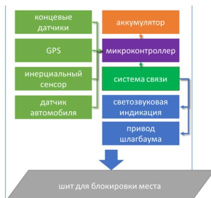
Рис. 2. Схема устройства для управления парковочными местами
