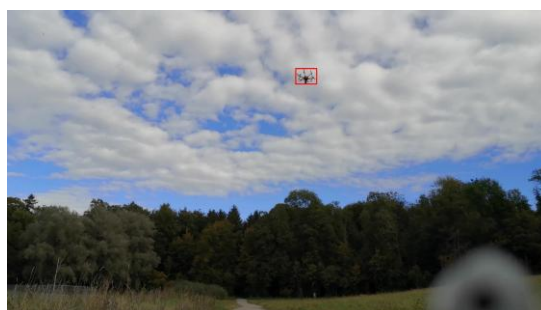
Рис. 5. Пример обработки изображения информационным модулем сопровождения объекта интереса (отмечена рамкой). Изображения взято из набора данных [21]
