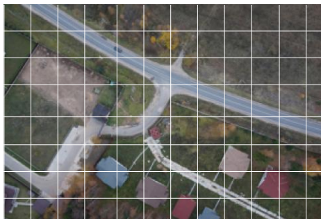
Рис. 5. Фотограмметрическая линейка для случая съемки в надир в видимом диапазоне с высоты 150 м
