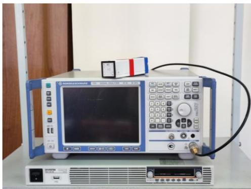
Рис. 1. Рабочее место для исследования помеховой обстановки
