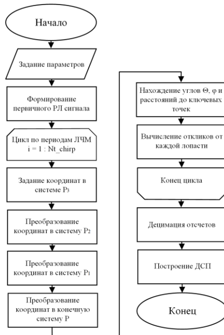
Рис. 1. Алгоритм модели рассеяния сигнала
