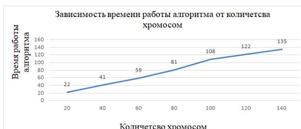
Рис. 10. Зависимость времени работы алгоритма от количества хромосом
