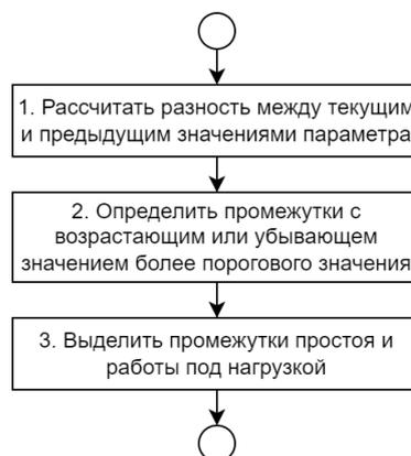
Рис. 4. Схема алгоритма выделения рабочих циклов
