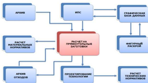
Рис. 6. Схема взаимодействия модулей в системе расчета раскроя
