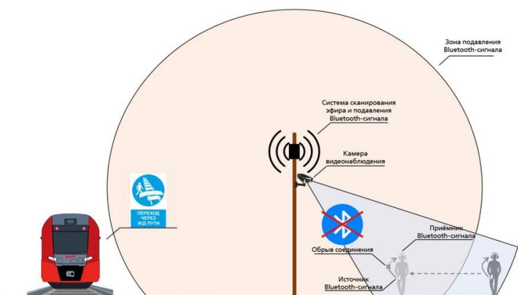
Рис. 6. Общий вид системы избирательного подавления беспроводных сигналов
