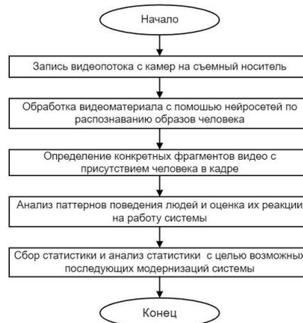
Рис. 11. Алгоритм метода оценки паттернов поведения пешеходов при подавлении беспроводной связи
