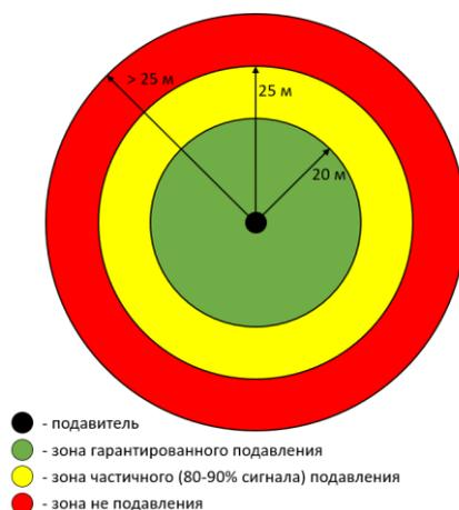
Рис. 17. Схема зоны действия подавителя
