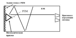
Рис. 8. Использование клина и ЭПР при измерении фона камеры
