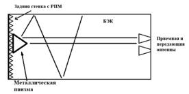
Рис. 6. Использования клина при измерении фона камеры
