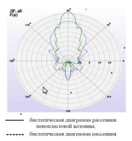
Рис. 1. Сравнение бистатических диаграмм обратного рассеяния пилона и колонны
