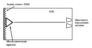
Рис. 7. Отражение от вершины при использовании клина для измерения фона камеры
