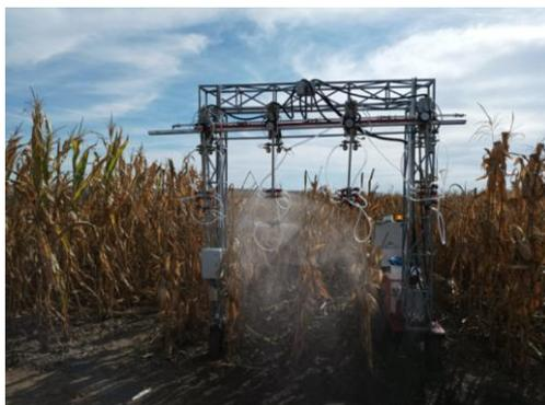
*Рис. 5. Автономный робот для мониторинга и опрыскивании посевов, который будет применяться для отработки федеративных методов обучения управляющих нейрокогнитивных архитектур*
