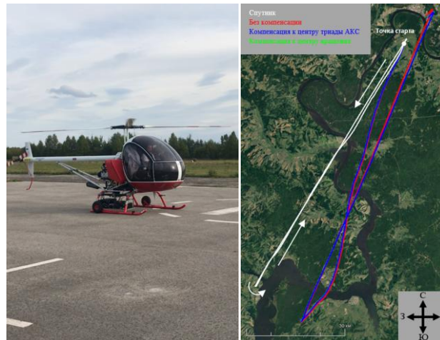
Рис. 10. Инерциальное навигационное решение на летных испытаниях
