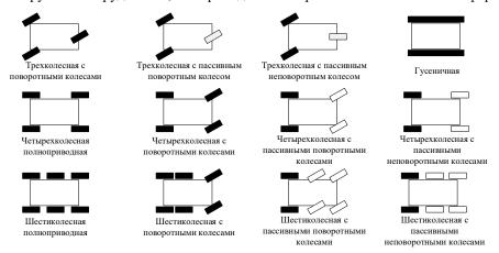
Рис. 2. Базовые кинематические схемы роботизированных платформ
