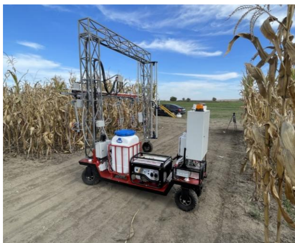
Рис. 3. Внешний вид автономного робота для защиты растений с установленными на нем опусками системы опрыскивания (во время испытаний в посевах кукурузы в КБР)
