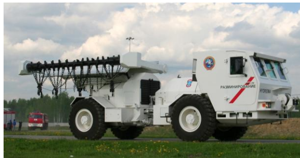
Рис. 1. Экипажная машина разминирования Hydrema 910 MCV
