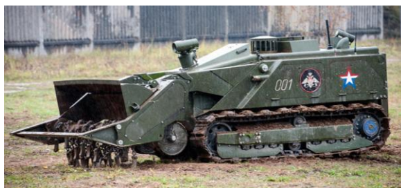
Рис. 3. Дистанционно-управляемая машина разминирования ДУМ-Р «Уран-6»
