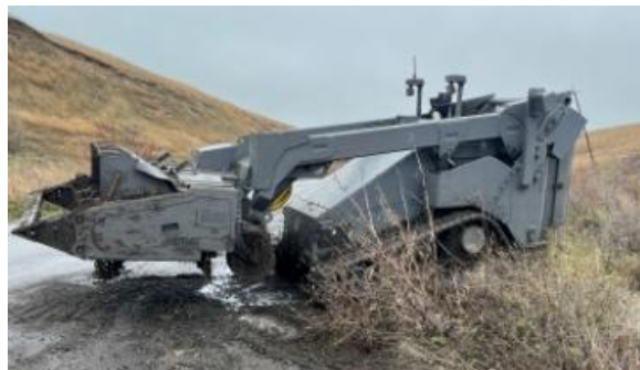
Рис. 4. Дистанционно-управляемый минный трал МТ-2
