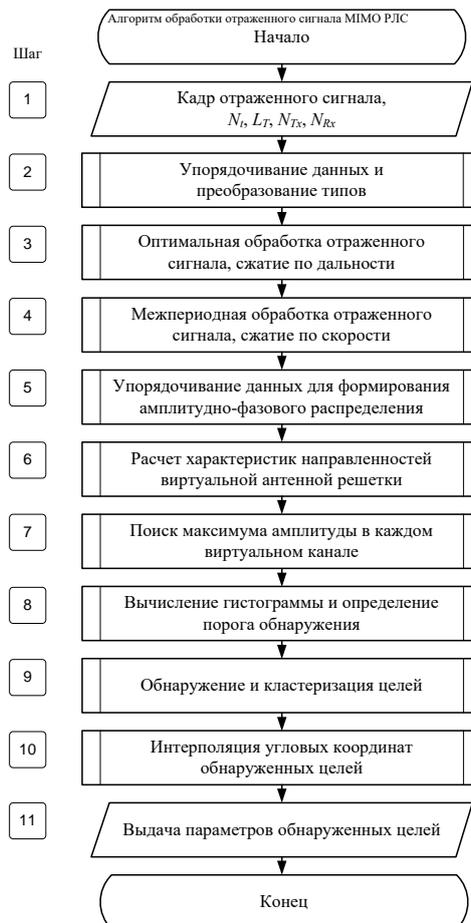
Рис. 3. Укрупненная блок-схема алгоритма обработки отраженного сигнала в рассматриваемой РЛС
