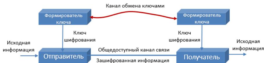
Рис. 1. Шифрование методом одноразового блокнота
