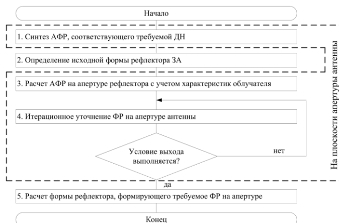
Рис. 1. Блок-схема предлагаемого алгоритма
