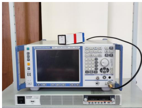
Рис. 1. Рабочее место для исследования помеховой обстановки
