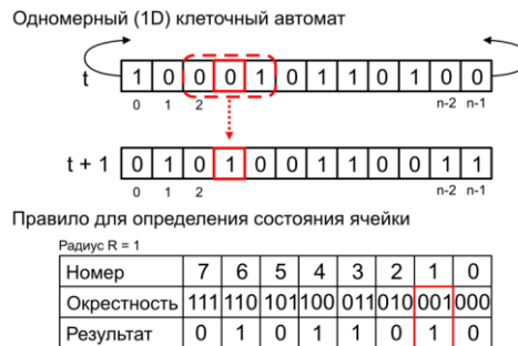
Рис. 3. Пример работы одномерного клеточного автомата за один период дискретного времени
