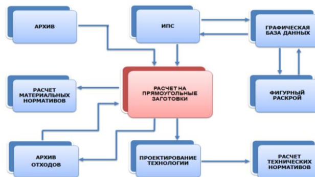
Рис. 6. Схема взаимодействия модулей в системе расчета раскроя
